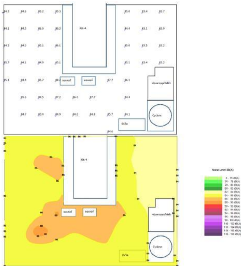
ภาพที่ 10 แผนผังแสดงระดับเสียง (Noise Contour Map) ในพื้นที่ Preheater TS.4 ชั้น 2
