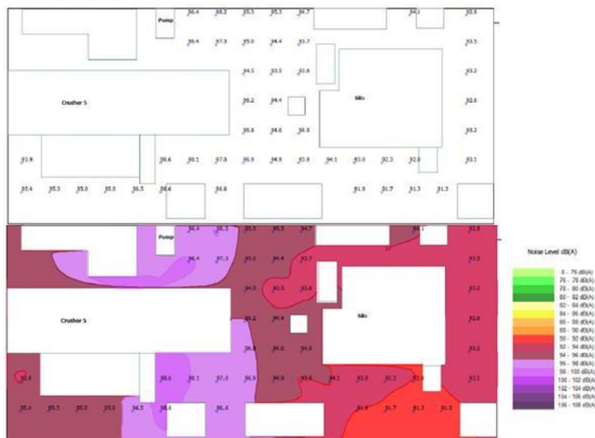
ภาพที่ 4 แผนผังแสดงระดับเสียง (Noise Contour Map) ในพื้นที่ Crusher 5
