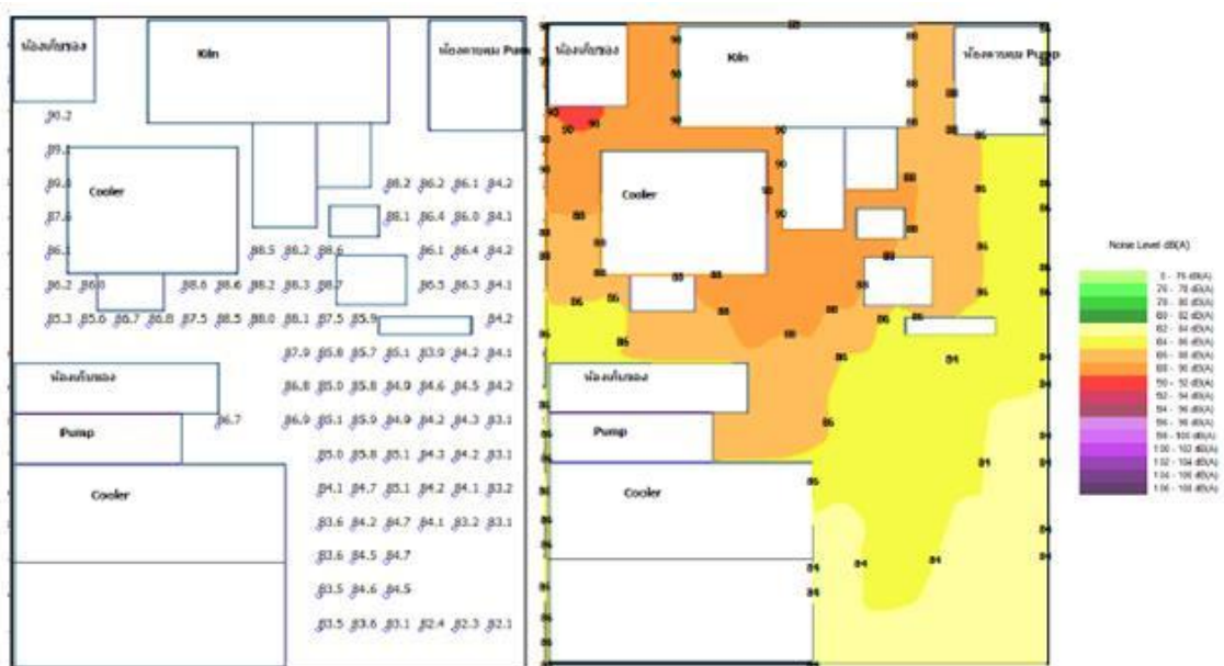
ภาพที่ 28 แผนผังแสดงระดับเสียง (Noise Contour Map) ในพื้นที่ Clinker Cooler TS.6 ชั้น 2
