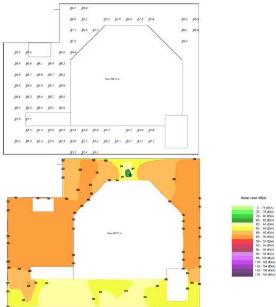
ภาพที่ 26 แผนผังแสดงระดับเสียง (Noise Contour Map) ในพื้นที่ Raw Mill TS.6
