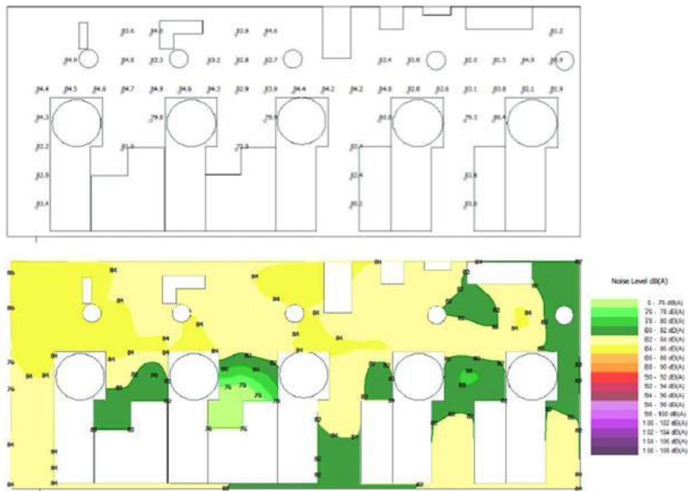
ภาพที่ 38 แผนผังแสดงระดับเสียง (Noise Contour Map) ในพื้นที่ Packer 5 ชั้น 2
